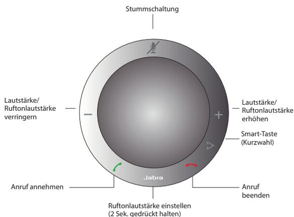
Verbinden Sie das Jabra Speak 410 USB-Kabel mit einem freien USB-Anschluss am PC oder spannungsversorgten Hub. Die Jabra LED leuchtet weiß auf, um anzuzeigen, dass die Freisprecheinrichtung verbunden und eingeschaltet ist.
